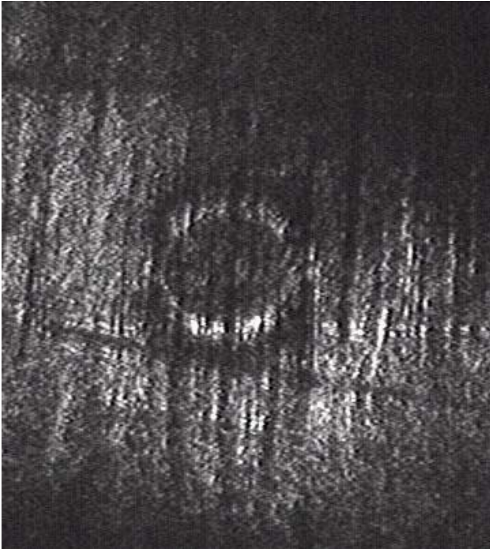
Рис. 2. Изображение интерферограммы участка поверхности алюминиевой пластины после сверления круглого отверстия сверлом диаметром 1 мм на глубину 0.5 мм. Для записи голограммы использована ГРС с ППК GCBE+1mass.%Dye9.
