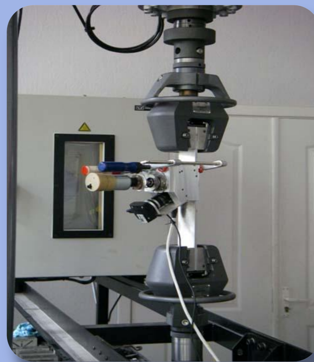
Тестирование интерферометра на испытательной машине INSTRON 8802
